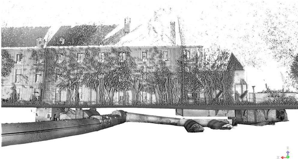
**Fig. 2 : Saint-Médard de Soissons 2020. Réseaux souterrains à l'intérieur de la propriété départementale (numérisation Grégory Chaumet, PLEMOD 3D).**
